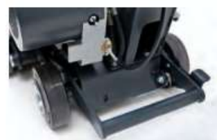
Pédale pour position de transport = déplacement rapide de la machine
