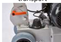
Réglage en continu de la hauteur de la tige de guidage
